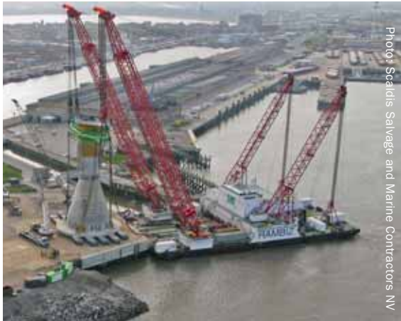
Shearleg crane barge Rambiz
